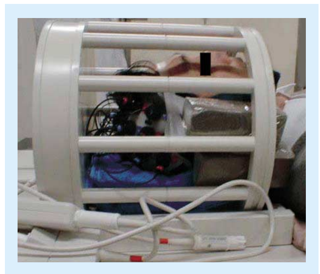
図3：MRI頭部コイル内光トポグラフィ用ファイバーの装着状況
