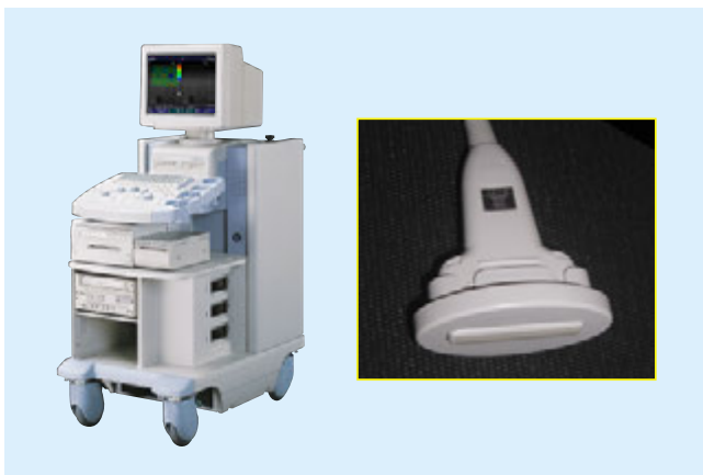
図 1 : 組織弾性システムを内蔵した EUB-8500(左)と均一な圧迫ができるために専用スタビライザーを装着した 7.5MHz の探触子(右)。
