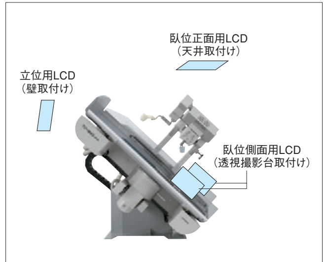
図3：被検者確認用液晶モニターの取り付け位置
