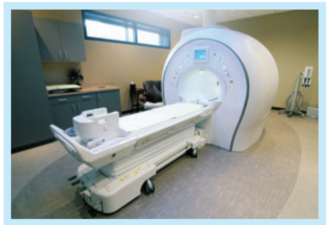
図1 : 世界に先駆けて ProScan Imaging に据え付けられた楕円形状ボアの 1.5T MRI システム ECHELON OVAL
