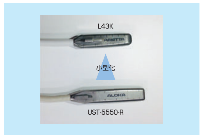
図2：UST-5550-R(下)と新規超音波プローブ(上) (※2)
