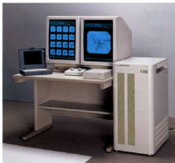
図1：リアルタイムDSA用画像処理装置
