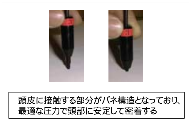
図8：プローブ先端部
