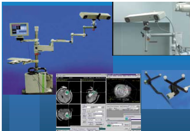
図3：光学式リアルタイムアップデートナビゲーションシステム 左：システム全景 右上：センシング用CCDカメラ 中央：ナビゲーション画面(3D・ログ機能搭載) 右下：センシング手術デバイス
