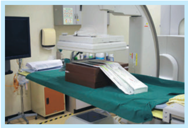
図4：カテーテルの視認性に関する実験風景 カテーテルの下の茶色い箱は水透過ファントム。
