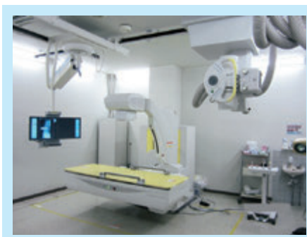
図2：X線透視撮影システム(CUREVISTA)と第2管球の天井吊X線装置
